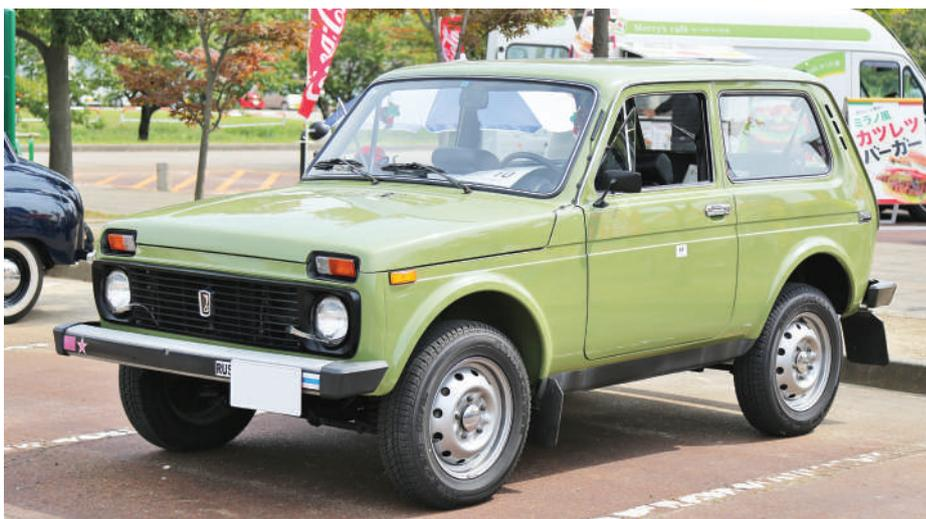
*Автомобиль повышенной проходимости — внедорожник малого класса с несущим кузовом и постоянным полным приводом ВАЗ-2121 «Нива»*
